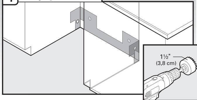
Si nécessaire, percer un trou de diamètre 1 1/2" (3,8 cm) dans la paroi du placard le plus proche de l'évier.
